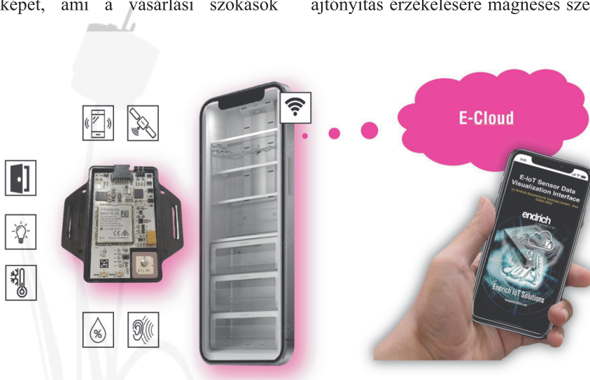
3] A szenzor-felhő direkt kapcsolatot megvalósító GSM hálózaton kommunikáló E-IoT telemetria egység
