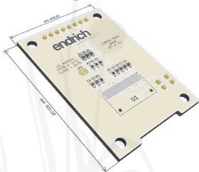
4) Az E-IoT hardver platform külső display kártyái
