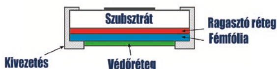
1. ábra. KRL-sorozat: A fémfólia-ellenálláselem a hordozó-kerámia-szubsztrátum aljára való ragasztásával kiváló hőleadó képességgel ruházta fel a gyártó a komponens
