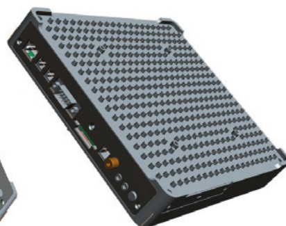
4. ábra. Docking station PC: erős, robusztus kivitel, dockingcsatlakozóval a megfelelő érintőpanel hátuljára való illesztéshez. A passzív hűtésű eszköz hosszú élettartamú és sok ipari interfészt kínál. Ipari hőmérséklet-tartományon működtethető: -10 °C – +60 °C, mérete 210×185 mm
