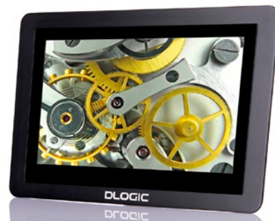
3. ábra. SDM: ARM-alapú okoskijelző LINUX operációs rendszerrel, számos ipari interfésszel, beépített érintőképernyővel
