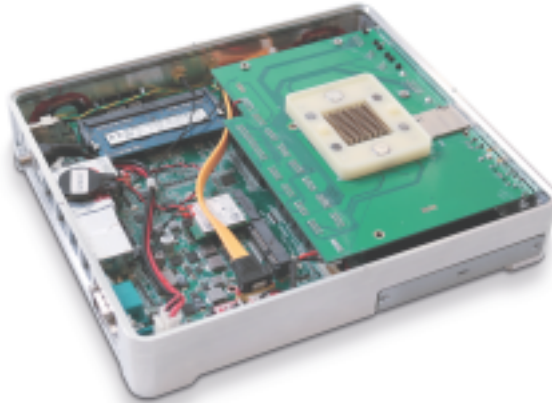
5| Docking station PC : A felső részen a 100 pólusú dokkoló csatlakozó, belül az alaplap elrendezése látható
