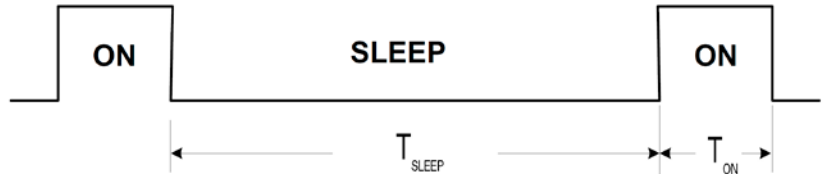
4. ábra. Ciklikus aktivitás és alvó állapot, az energiafogyasztás a kitöltési tényezőtől függ ( T_{ON}/T_{SLEEP} )
