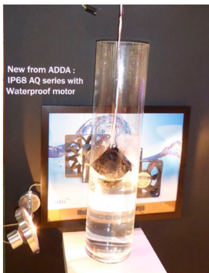
1. ábra. Az ADDA IP68 vízbe „mártva” is működik
